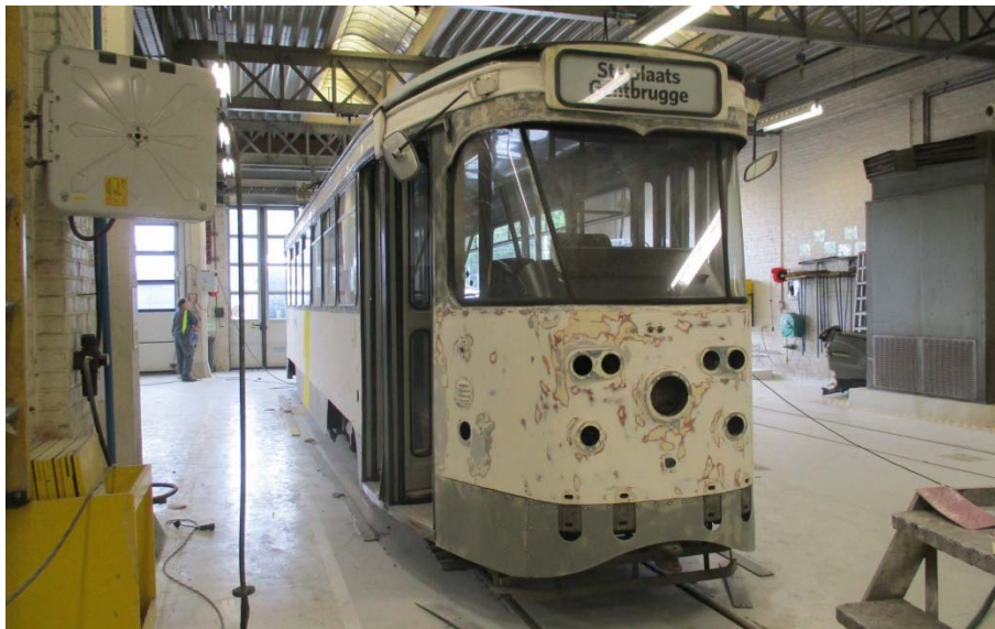
Einde mei 2016 : in de werkplaats is gestart met het volledig opschuren van het koetswerk.
